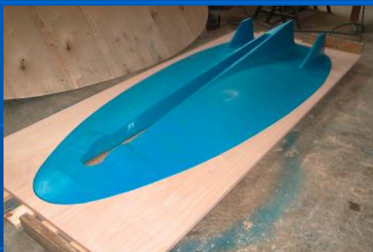
Copie de la pièce prête à livrer au fondeur
